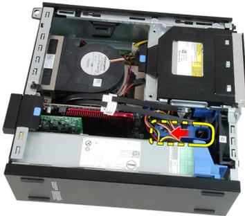
6. Putar sangkar drive ke atas menggunakan handel dan angkat untuk melepaskan sangkar drive dari sasis.
