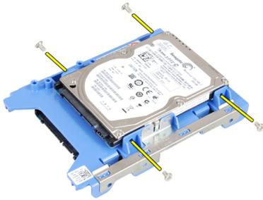
7. Lepaskan keempat sekrup yang menahan hard disk 2,5 inci ke bagian bawah braket hard disk.
